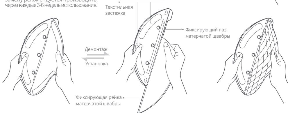
**Демонтаж матерчатой швабры:** как показано на изображении, нажать на две защелки держателя матерчатой швабры и горизонтально в направлении наружу извлечь держатель матерчатой швабры; затем оторвать текстильную застежку и вытащить фиксирующую рейку матерчатой швабры из фиксирующего паза.
